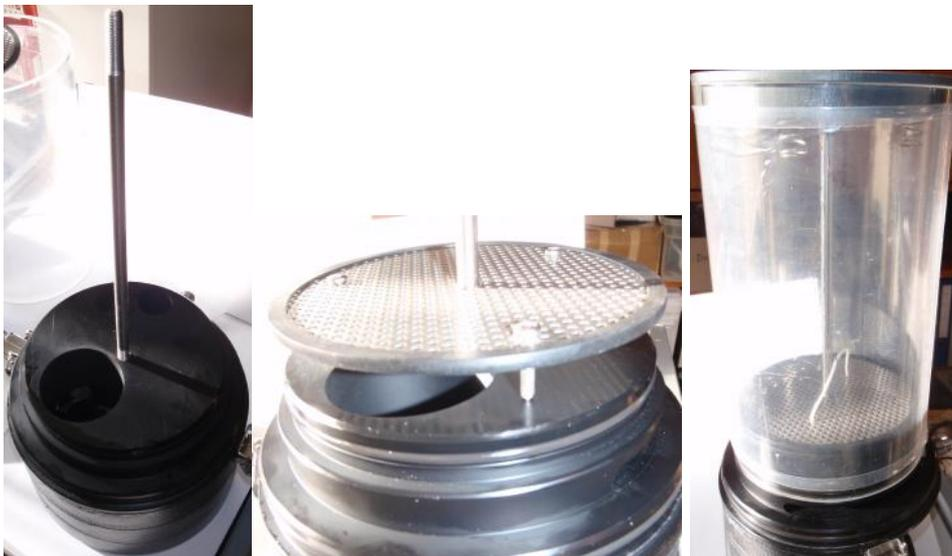
Abb. Einsetzen der Gewindestange, Aufsetzen des Kopfsiebes, fertiger Kalkbehälter
