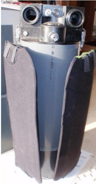
Abb. Atembeutel fertig am TR300c Gehäuse
